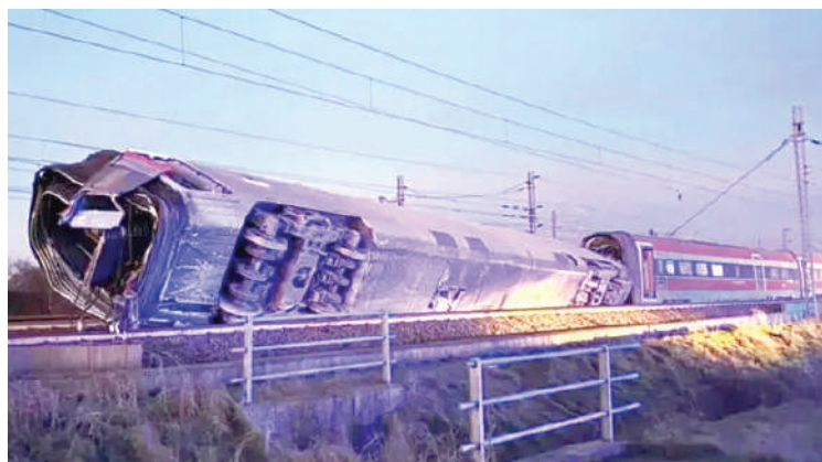
Los trenes impactaron debido al descarrilamiento que sufrieron ambos.
