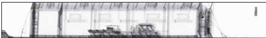
Mediante inspección con rayos gamma se verifica que contenedores traen los hospitales.
