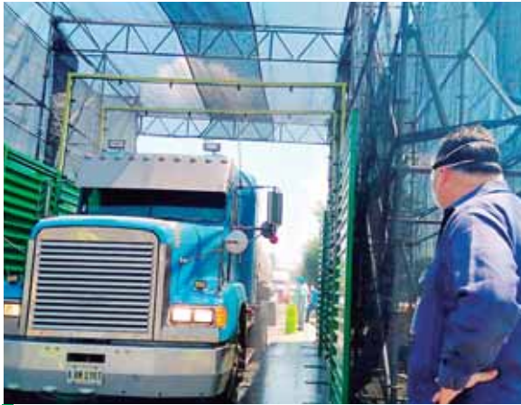
Los arcos de fumigación están compuestos por tres tanques, una bomba que genera presión y un generador.
