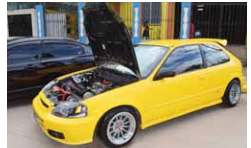
Un Honda Civic Hatchback 2000 con motor D16y8 con admisión Science 2, header, regulador de combustible con caja de relación.
