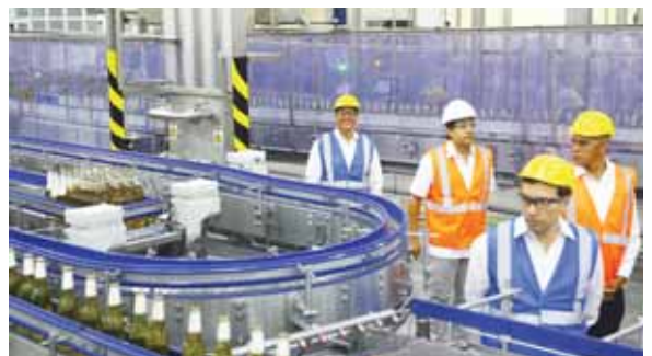
La línea de envasado tiene capacidad de operar en una hora alrededor de 50 mil botellas del producto.
